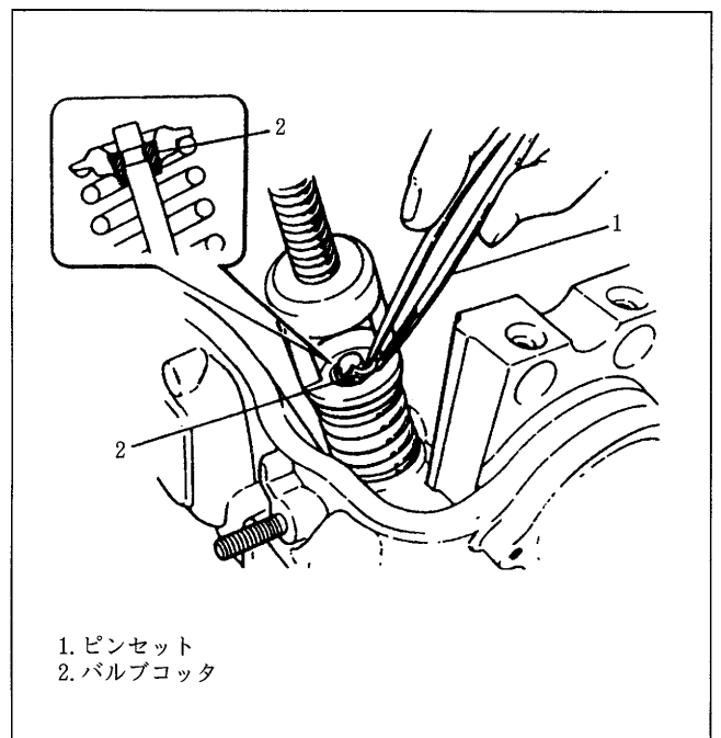
図1A-18-5 バルブコッタの取外し
